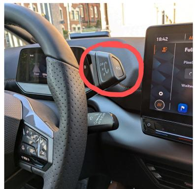
**Zum Beenden der Fahrt** wird der Elektroantrieb durch Drücken des "P"-Knopfes am Schalthebel deaktiviert.
