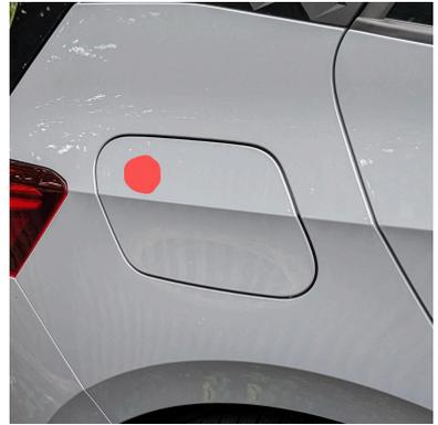
**Normalladen** mit Typ 2-Stecker bis max. 11 kW.
