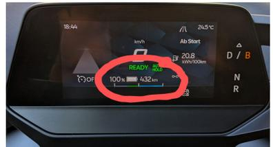
**Zum Losfahren** das Bremspedal drücken und eine Fahrstufe auswählen: Vorwärts mit "D/B" oder Rückwärts mit "R". Der Hebel befindet sich rechts hinter dem Lenkrad.
